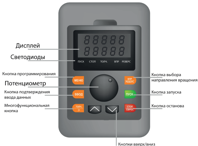
Рис. 5.1.1 Функции кнопок и светодиодов панели управления
