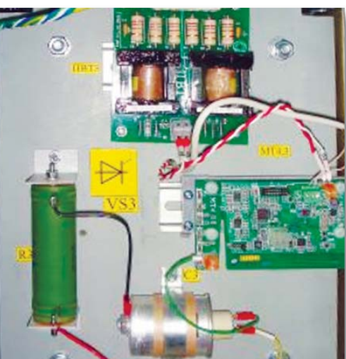
Тиристорный блок с установленным монитором тиристора MT
