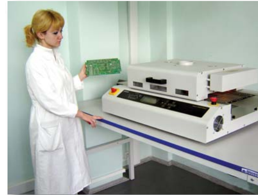
Процесс конвекционной пайки плат
