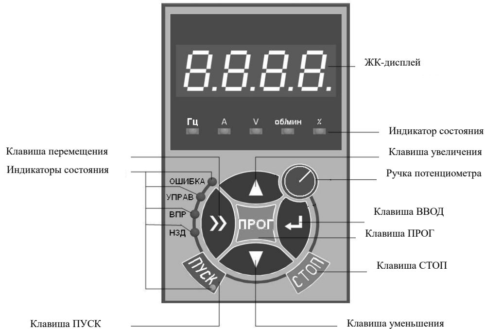
Рис. 4-1 Рисунок панели управления
