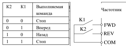
Рис.6-13 Двухпроводной режим управления 1
