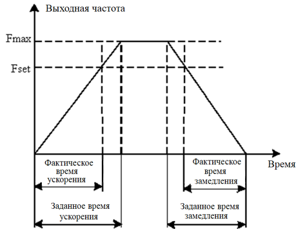
Рис. 6-2 Схема времени ускорения/замедления
